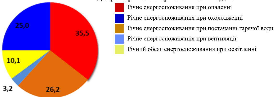
Діаграма річного енергоспоживання будівлі
